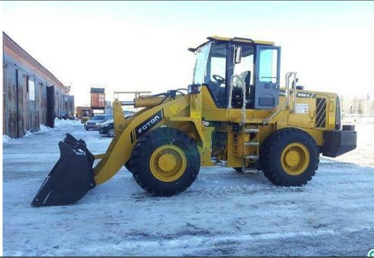
Погрузчик фронтальный представляет собой транспортное средство, оборудованное приспособлением для захвата и перемещения объектов, выполнения карьерных работ и буксировки сыпучих или штучных материалов в пределах строительной площадки
