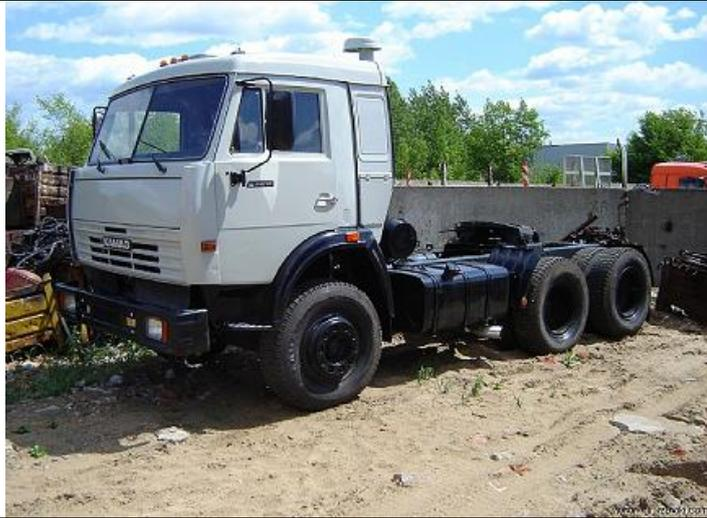
КамАЗ 5410 предназначен для тяжелых перевозок и способен перемещать грузы общей массой до 30 тонн. Этот мощный грузовик оборудован колесной базовой системой 6x4 и сцепной конструкцией с двумя поворотными звеньями.
